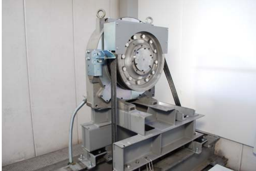
PM(永久磁石:Permanent Magnetic)モーターを採用した新型ギヤレス巻上機
